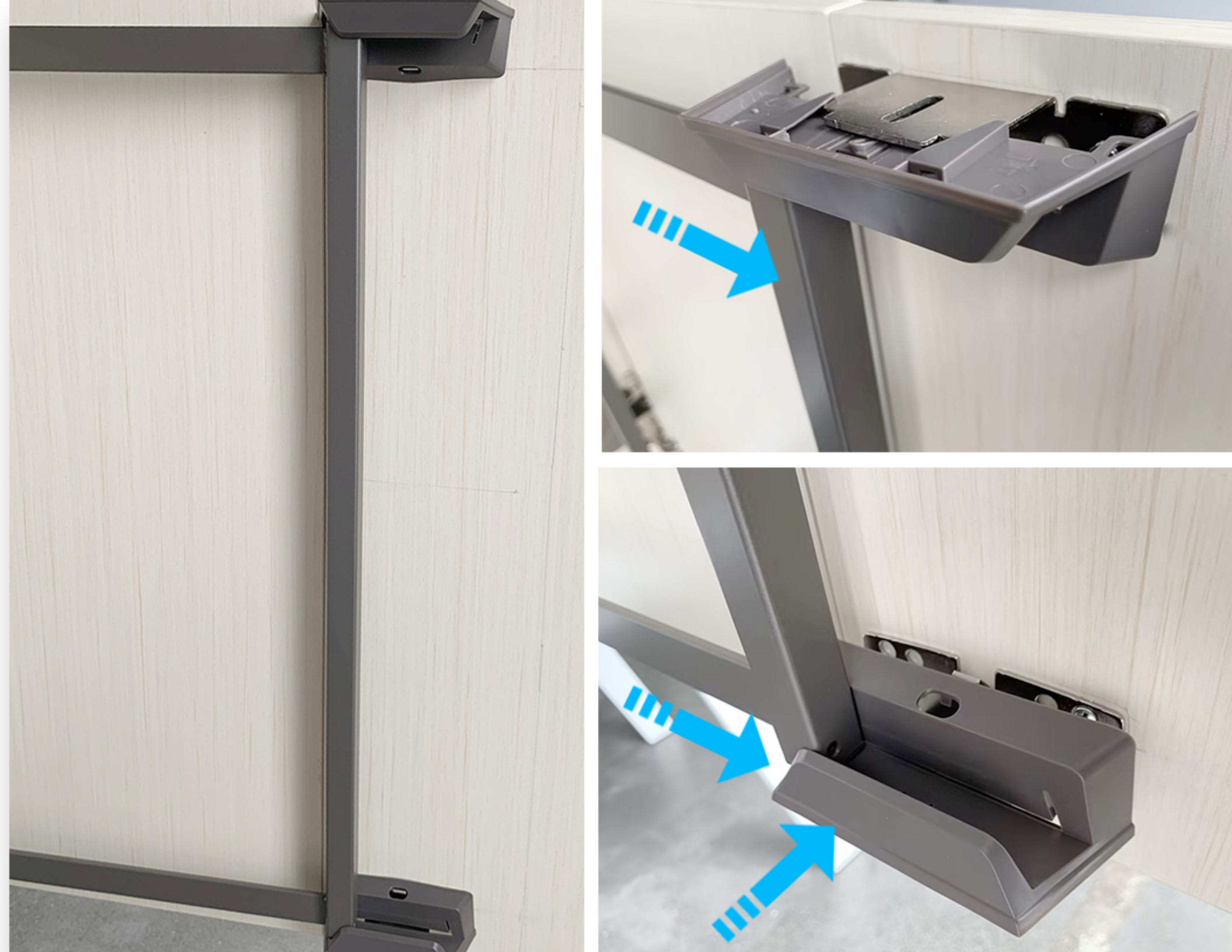
侧框滑入导槽并把将导槽卡在固定件中 上、下同时安装
