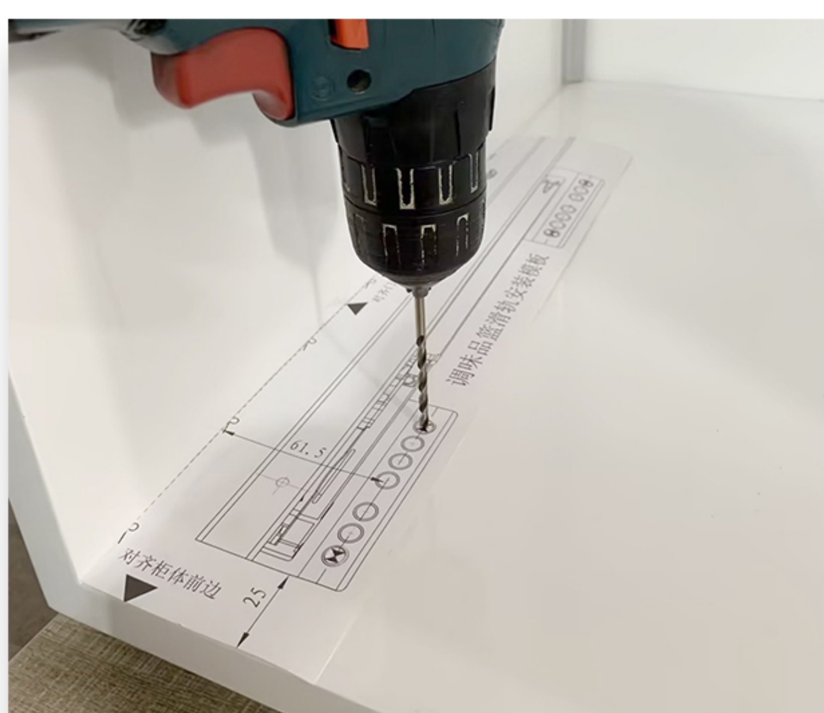
滑轨预钻孔 模板齐平面板顶线（左/右）
